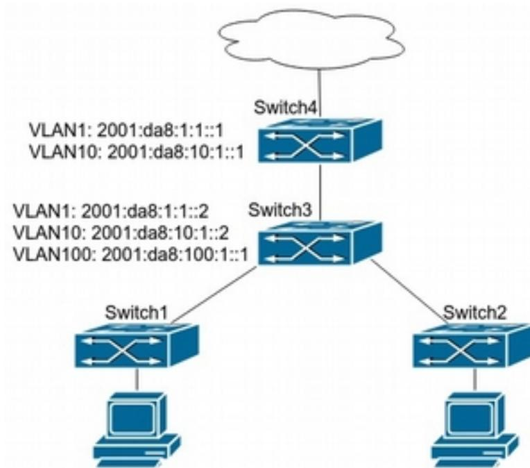
Рисунок 44.2 Пример настройки опций 37 и 38 для DHCPv6 relay
