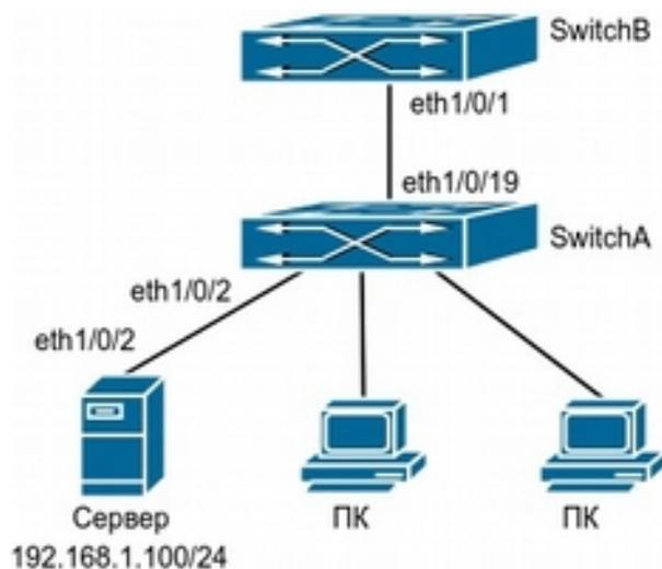
Рис. 36-1 Пример топологии применения функции предотвращения ARP-сканирования
