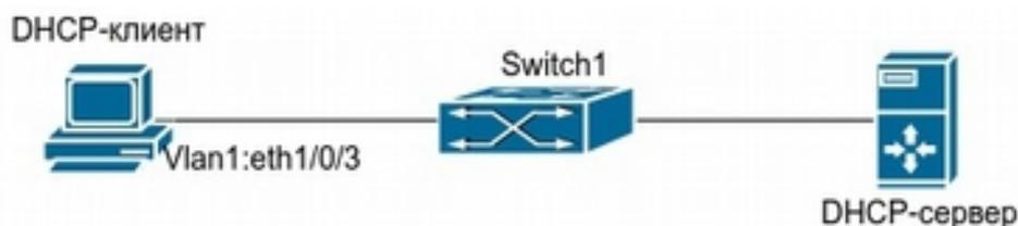
Рис.42.3 настройка опции 82 для DHCP snooping
