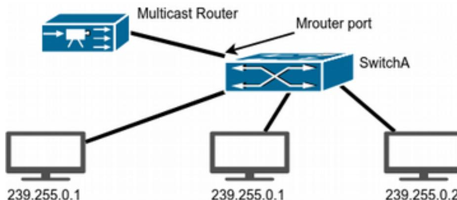
Рисунок 21-1 IGMP Snooping
