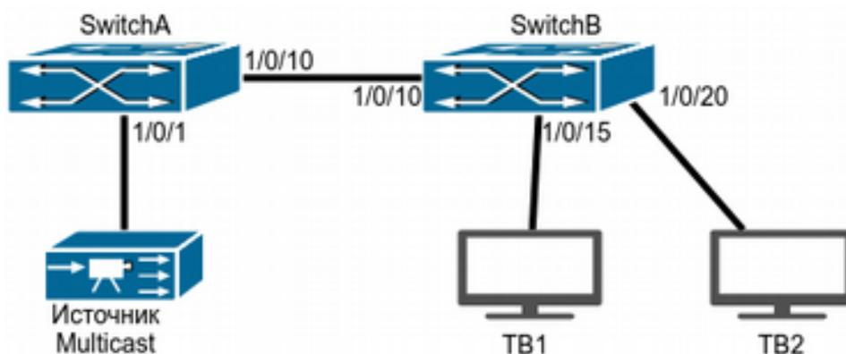
Рисунок 49.1 Настройка Multicast VLAN
