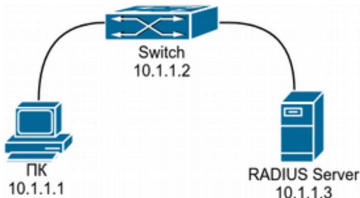
Рисунок 57.2 Конфигурация RADIUS
